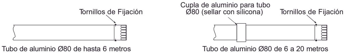
La instalación de la salida de humos para un sistema de conductos separados contempla los tubos de expulsión de gases (Ø80) y de aspiración de aire (Ø80) y el sombrerete terminal. Los conductos pueden ser de hasta un máximo de 20 mts cada uno o su equivalente (cada codo de 90° equivale a una reducción de longitud del conducto de 1,30 metros).
